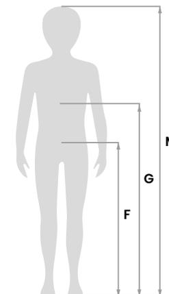
Assicurarsi che le altezze F e G rappresentate in figura, rientrino nel range di misura indicato per il supporto pelvico e toracico.
